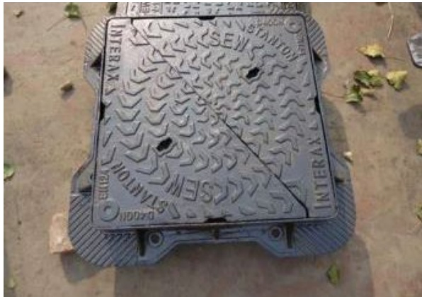
双开矩形球墨铸铁检查井盖 (A 井 井盖 600mm*900mm) 示意图 检查井盖承载力不低于 D400 (图四)
