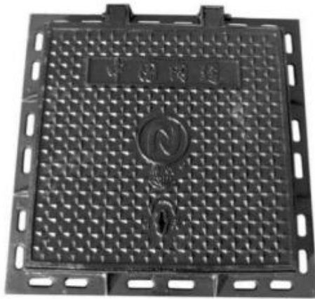
单开矩形球墨铸铁检查井盖 (B 井 井盖 400mm*600mm) 示意图 检查井盖承载力不低于 D400 (图五)
