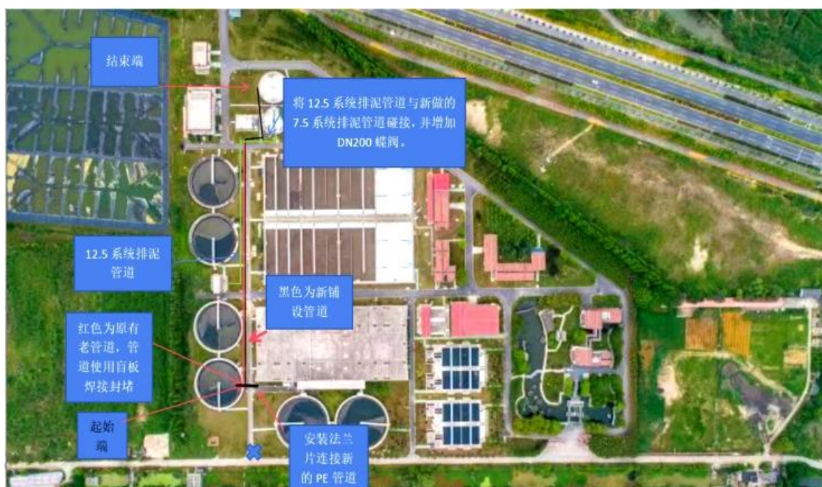
附图 1 管道铺设路线
