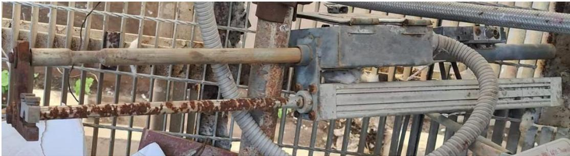
2、高能点火器 XDH-20C ， 2套，详细的技术参数：输入电压 220VAC，输出电压 2500VDC, 贮能 20J，带高压延长线
