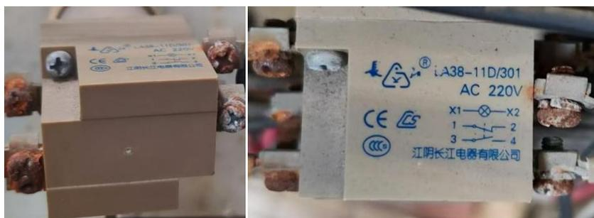
6、旋钮开关 LA38-11X2/209B ，4 个，详细的技术参数：AC-15: 110/220/380V
